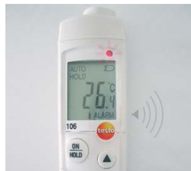
Akustický a optický alarm (svítí LED dioda)
