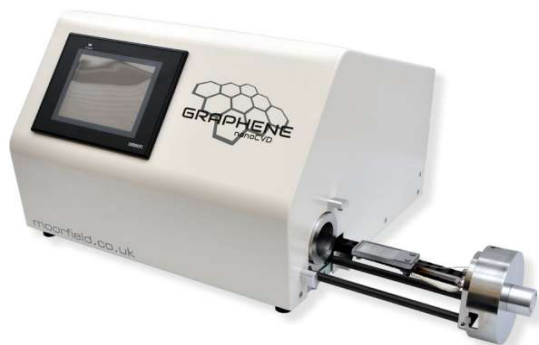
Obr. 1. Fotografie CVD aparatury nanoCVD-8G. V pravé části fotografie je vytažen vyhřívací stoleček, na který se pokládají podložky pro růst grafenu.
