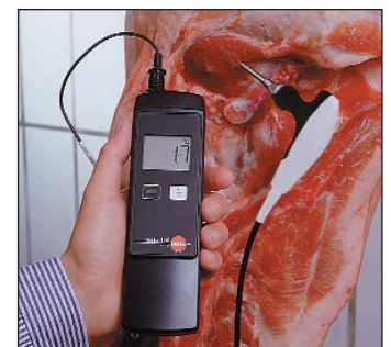
Měření teploty jádra, např. při dodávkách čerstvého masa. Měřeno robustní vpichovací sondou se speciální rukojetí.
