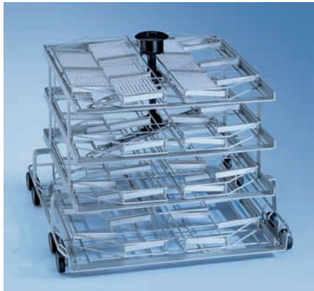
E 493 vozík Lze používat v PG 8536 CD • pro 8 nástavců E 494 pro mikrotitrační destičky ve 4 úrovních • Spodní ostříkovací rameno přístroje musí být pro optimální výsledek mytí vyměněno za přiloženou objímku. • rozměry pro osazení odspodu: 1. úroveň: 70 mm 2. úroveň: 85 mm 3. úroveň: 85 mm 4. úroveň: 90 mm
