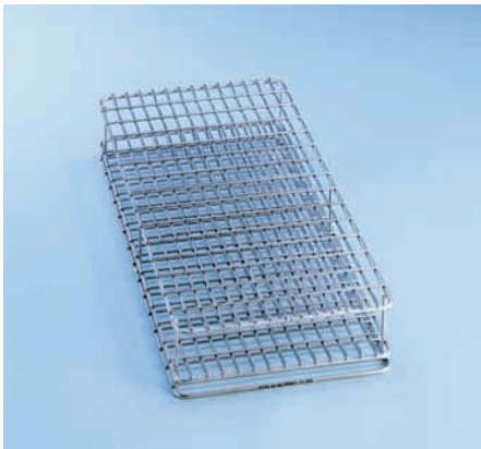
E 134 nástavec 1/2 Lze používat v G 7883, G 7893, G 7883 CD, PG 8535 CD a PG 8536 CD, O + U • k uložení 210 podložních sklíček • 210 přihrádek 26 x 11 mm • 3 mm drátěné pletivo • V 73, Š 200, H 445 mm
