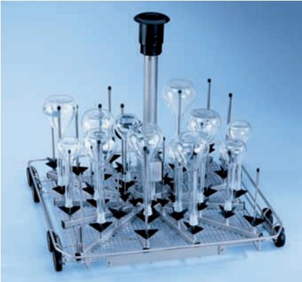
E 414 injektorový vozík 1/1 TA Lze používat v G 7893, G 7883 CD, PG 8535 CD a PG 8536 CD • jako E 329, avšak s 37 tryskami • s přípojkou pro horkovzdušné sušení (TA) • držák pro magnetickou lištu ML/2 pro automatické rozpoznání vozíku
