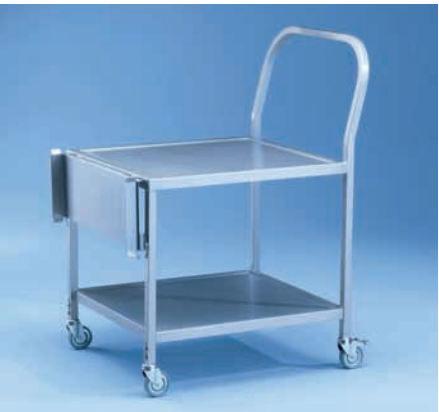
MC/1 Mielcar, zavážecí a vyvážecí vozík • pro zavážení a odvážení košů a nástavců z/do mycího a dezinfekčního automatu • 2 úložné úrovně (korýtkové) • obloukovitá rukojeť a navíjecí plech • najížděcí rovina V 640–885 mm, plynule přestavitelná • 4 kolečka, z toho 2 s možností zajištění • V 1 000, Š 630, H 814 mm (u vysoko sklopného navíjecího plechu H 960 mm)
