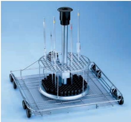
E 406 injektorový vozík Lze používat v G 7883 • pro 116 pipet do 450 mm • velikost ok 16 x 16 mm • kompletní s nosným rámem ve výšce 150 mm • V 502, Š 533, H 516 mm
