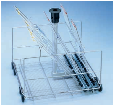
E 404/1 injektorový vozík Lze používat v G 7883 • pro uložení 38 pipet ve 3 řadách: 1. řada 10 pipet – 100 ml (do délky 550 mm), vzdálenost držáků, 20 mm 2. řada 14 pipet – 25 ml vzdálenost držáků, 26 mm 3. řada 14 pipet – 10 ml vzdálenost držáků, 26 mm
