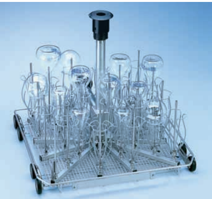
E 380 injektorový vozík 1/1 TA Lze používat v G 7893, G 7883 CD, PG 8535 CD a PG 8536 CD • jako E 350, avšak s 32 tryskami/aretacemi • s přípojkou pro horkovzdušné sušení (TA) • držák pro magnetickou lištu ML/2 pro automatické rozpoznání vozíku
