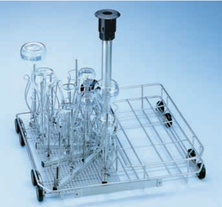
E 385 injektorový vozík 1/2 TA Lze používat v G 7893, G 7883 CD, PG 8535 CD a PG 8536 CD • jako E 355, avšak s přípojkou pro horkovzdušné sušení (TA) • držák pro magnetickou lištu ML/2 pro automatické rozpoznání vozíku
